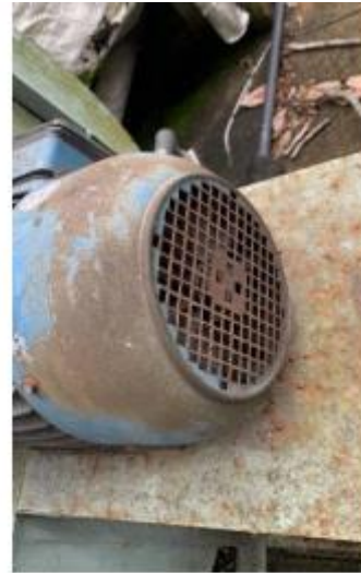
Peça: Motor do exaustor Avaria: Queimado
